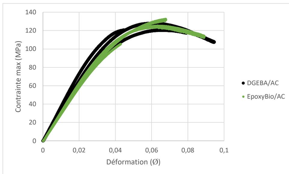
Figure 6 : Courbes contrainte-déformation obtenues en flexion 3 points
