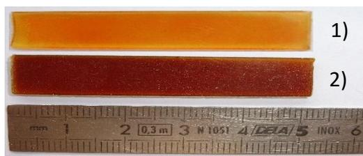
Figure 3 : Epreuves de polyépoxyde 1) DGEBA/AC 2) EpoxyBio/AC
