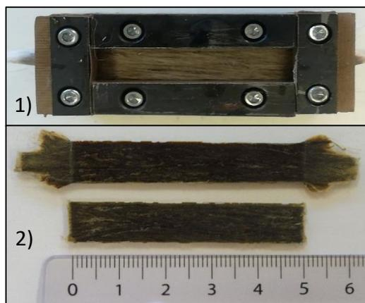
Figure 4 : Préparation des épreuves de composite 1) Moule avec mèches de chanvre alignées et fixées 2) Epreuves de composites
