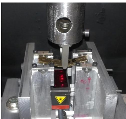
Figure 5 : Dispositif d'essai de flexion 3 points
